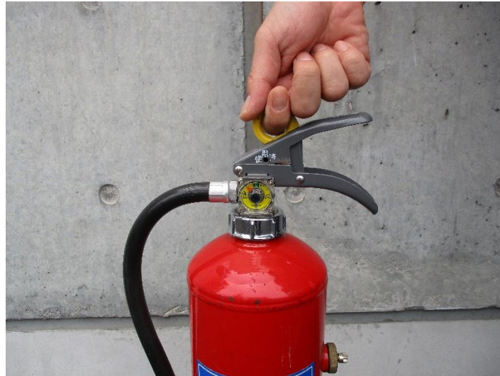
①黄色の安全栓（ピン）を引き抜く。
