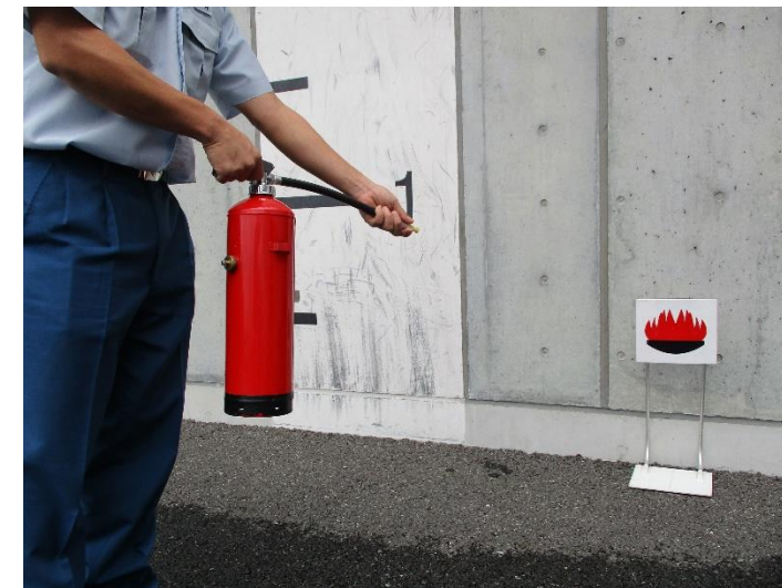
④手前からほうきで掃くようにホースを操作して、安全に消火できる距離まで進む。
