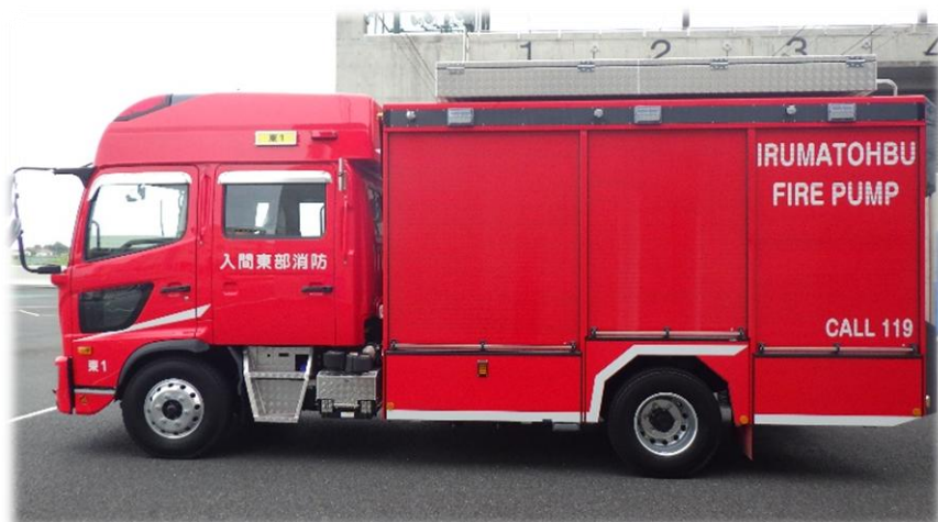
1 水槽付消防ポンプ自動車 (西消防署)
